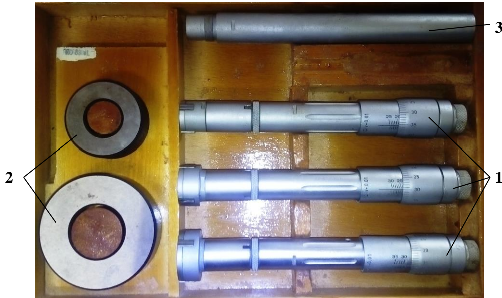
Fig. 6. Holtest set a.- micrometers; b.- ring gauge set; c.- extender
